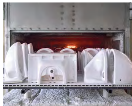
Une pièce brute émaillée se transforme en produit fini après avoir passé environ 16 heures dans un four chauffé jusqu'à 1 200 °C.
