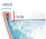
CUVETTE TRADITIONNELLE avec bride | avec rebord
