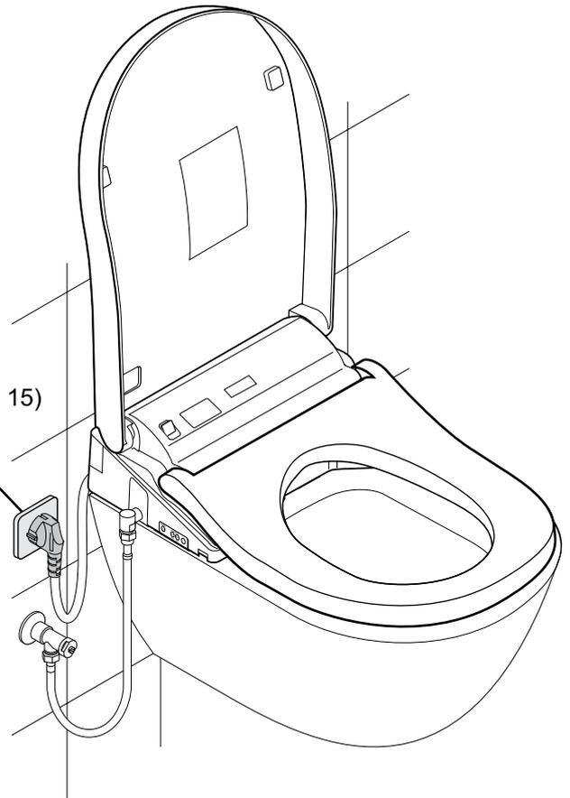
Nach Einstecken des Netzsteckers in die Netzsteckdose erfolgt ein automatisches Öffnen des Toilettendeckels erst nach 10 bis 60 Sekunden (weil sich das Gerät noch in der Anlaufphase befindet). Öffnen und schließen Sie den Deckel in dieser Zeit manuell.
