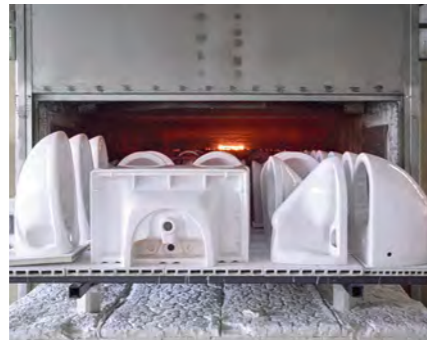
Im bis zu 1.200 °C heißen Brennofen wird in etwa 16 Stunden aus dem glasierten Rohling ein fertiges Produkt.
