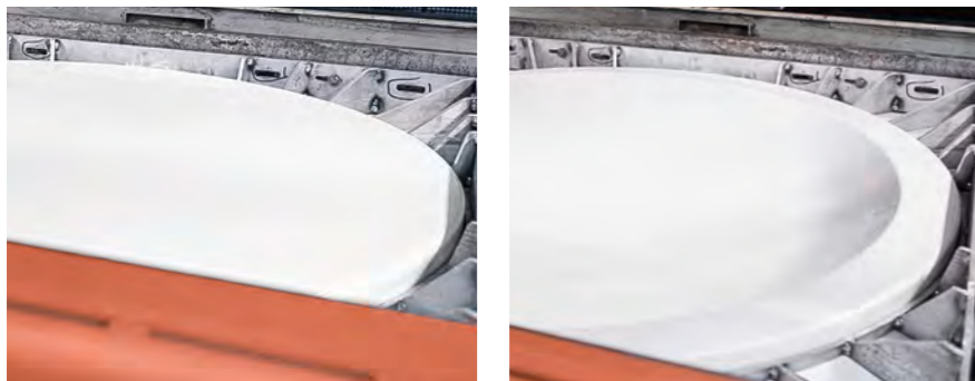
Beim Thermoformen werden Acrylplatten erhitzt und mittels Unterdruck in das Formwerkzeug gezogen. Das abgekühlte Formteil wird anschließend präzise geschliffen und poliert.
