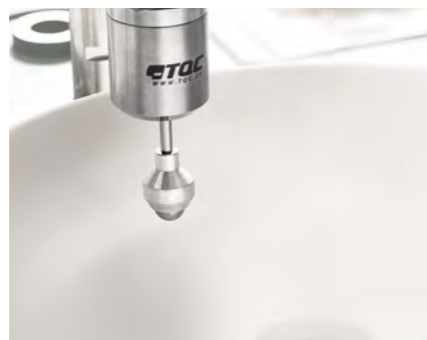
Die besondere Beständigkeit ist durch den Kugelfalltest belegt.
