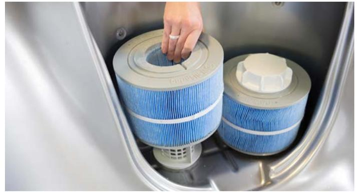
**Schritt 4:** Verwenden Sie zur Reinigung des/der Filtereinsatzes/-einsätze einen Gartenschlauch mit Düse oder ein anderes Hochdruckreinigungsgerät. Bearbeiten Sie jede Lamelle des Einsatzes zunächst innen von oben nach unten, dann außen von oben nach unten.
