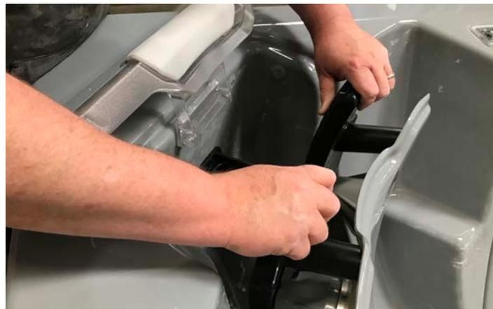
**Schritt 3:** Entfernen Sie den Simplicity-Filterhalter. Greifen Sie nach unten in den JetPod-Bereich und ziehen Sie den Filter am Griff zur Mitte des Whirlpools hin. Heben Sie ihn dann nach oben ab. Legen Sie die Filtereinheit mit dem Filter nach oben auf einer ebenen Fläche ab.
