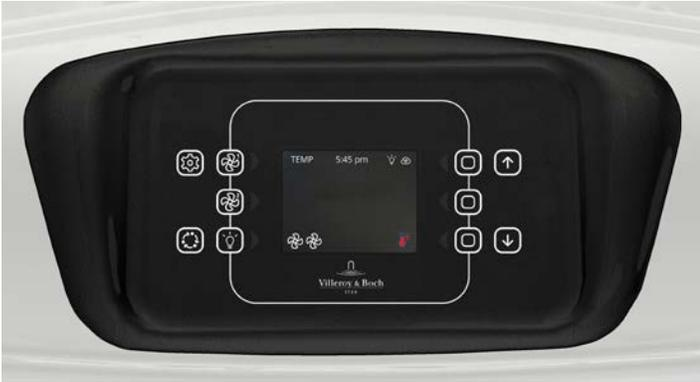
Konfiguration der Whirlpool-Steuerung angezeigt wird. Ein paar Sekunden später erscheint auf Ihrem Bedienfeld die Standard-Statusanzeige mit Uhrzeit, Düsen- und Lichtstatus, Temperatur, Betriebsmodus usw.
