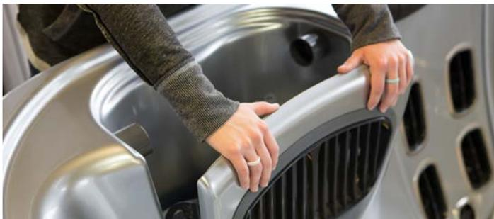
**Schritt 3:** Entfernen Sie den/die Lamellen-Filtereinsatz/-einsätze durch Drehen der Filterkernkappe(n) gegen den Uhrzeigersinn, dann schieben Sie den Einsatz/ die Einsätze vom Filterkern hoch.
