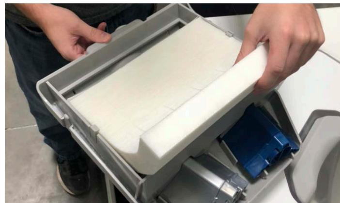
**Schritt 5:** Legen Sie den Simplicity-Filter wieder in den JetPod ein. Dabei muss der Griff nach oben zeigen. Legen Sie die Unterseite der Filtereinheit mit dem Griff nach oben am Gehäuse an und lassen Sie sie mit einer Rück- und Abwärtsbewegung im Gehäuse einrasten.
