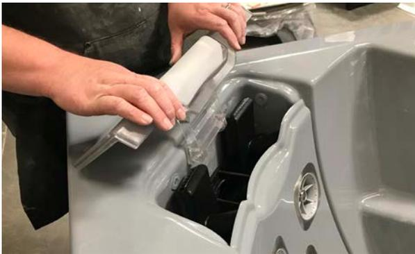
**Schritt 2:** Führen Sie den Gartenschlauch in den Innenraum hinter dem JetPak ein.
